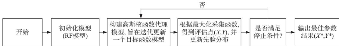
图 2 实现 BO-RF 算法的流程图
